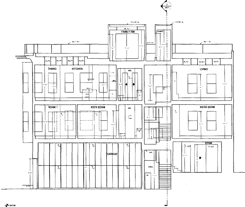
1 EXISTING LONGITUDINAL SECTION SCALE: 1/4"=1'-0"
