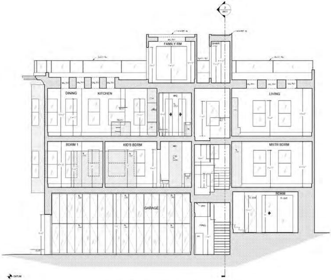
① EXISTING LONGITUDINAL SECTION SCALE: 1/8"=1'-0"
