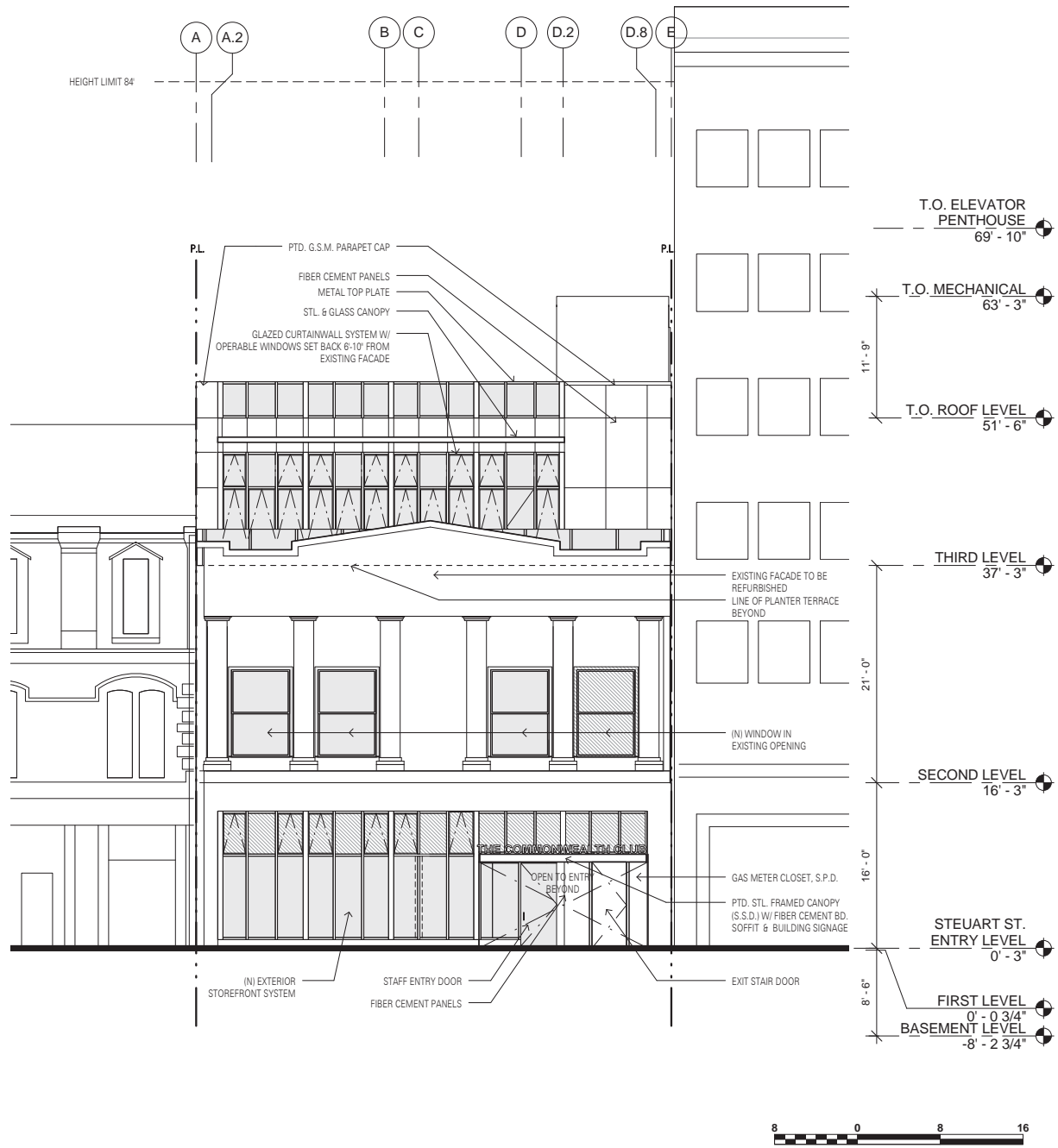
2 WEST EXTERIOR ELEVATION - STEUART STREET A3.1 SCALE: 1/8" = 1'-0"
