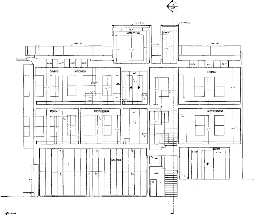
1 EXISTING LONGITUDINAL SECTION SCALE: 1/4"=1'-0"
