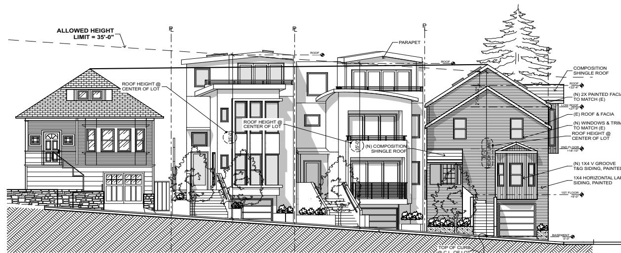
4 95 NORDHOFF EAST ELEVATION SCALE: 1/8" = 1'-0"
