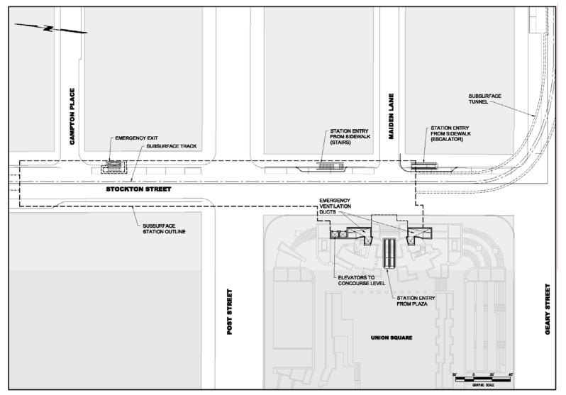
FIGURE 2-9: ENHANCED EIS/EIR ALIGNMENT - UNION SQUARE STATION
